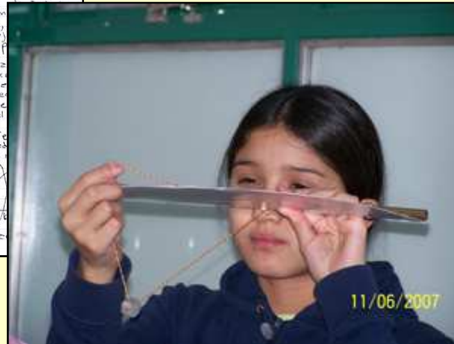
MEDIDA DE LA POSICIÓN DE OBJETOS EN EL CIELO (ACIMUT Y ALTURA) UTILIZANDO UN SEXTANTE DE AULA.
