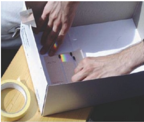
Fig.4: Situando los tres termómetros, con el bulbo negro, y el espectro en la parte de la sombra.
