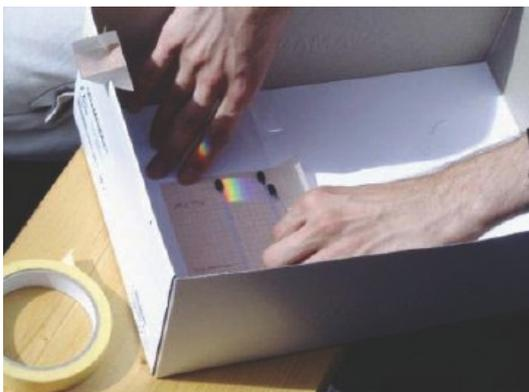
Fig.4: Colocação dos 3 termómetros, com os bulbos pretos, e o espectro na sombra.
