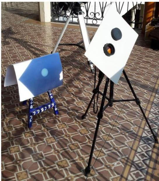
**Figura 17.** Telescopio reflector newtoniano dispuesto para la observación solar, con filtro de reflexión colocado a la entrada del tubo (S. Paolantonio).
